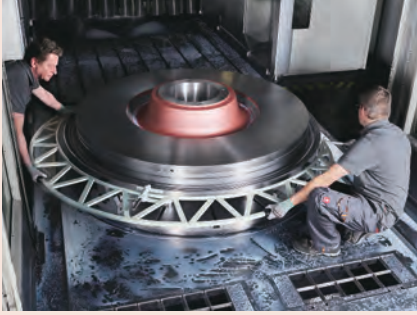
İş parçası üzerinde ayarlanabilir durdurmalı uygulama
