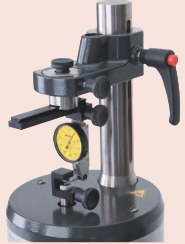
Komparatör saati kalibrasyonu (Salgı Tip) opsiyonel aksesuarlar ile
