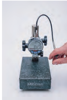
Mil kaldırma kablosuyla uygulama
