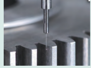
MPP-NANO Modül 0.8 master dişli ölçümü
