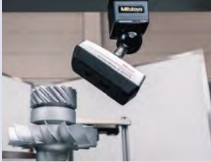
Flying spot türü, bu pervane gibi zor kısımları tam olarak tarayabilir ve sınıfta en yüksek tarama doğruluğunu sağlar.
