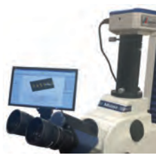
Gelişmiş gözlemler için 0,5X C montaj adaptörlü (63AAA067) Invenio dijital kamera (63AAA058)
