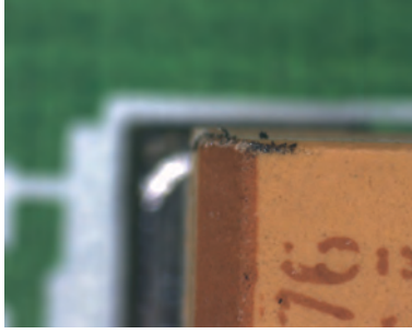
Normal mikroskop gözlemi (üst) Yükseklik farkıyla yalnızca üst veya alt düzleme odaklanılabilir.
