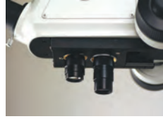
2 lens montajlı isteğe bağlı kayar tip burun parçasının kullanılması (fabrikada takılan seçenek)
