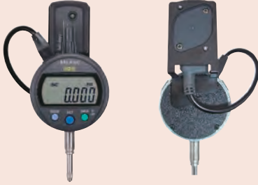
02AZE200 U-WAVE-T için tutucu Gösterge a.s.o.
