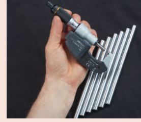
U-WAVE Uyumlu kablosuz sistemli Mikrometre
