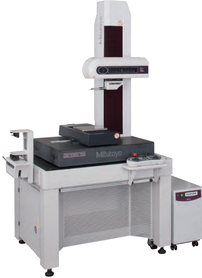
SV-C4500CNC iki adet güçlü değiştirilebilir sürücü ünitesiyle donatılmıştır
