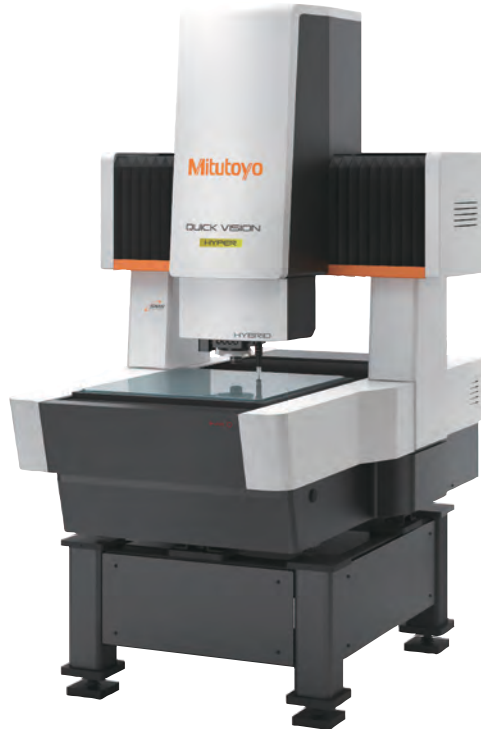
Temasla Tetiklemeli Prob ile Donatılmış CNC Görüş Ölçüm Sistemi
