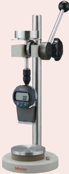
Test standı - Çalışma alanı çapı: Ø90 mm - Max. numune yüksekliği: 90mm
